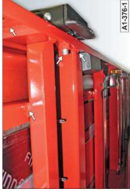
Fig. 73 Collegamento trasversale del supporto per montanti
