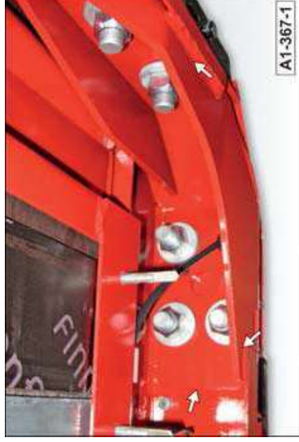
Fig. 65 Collegamento dei montanti angolari, anteriore
