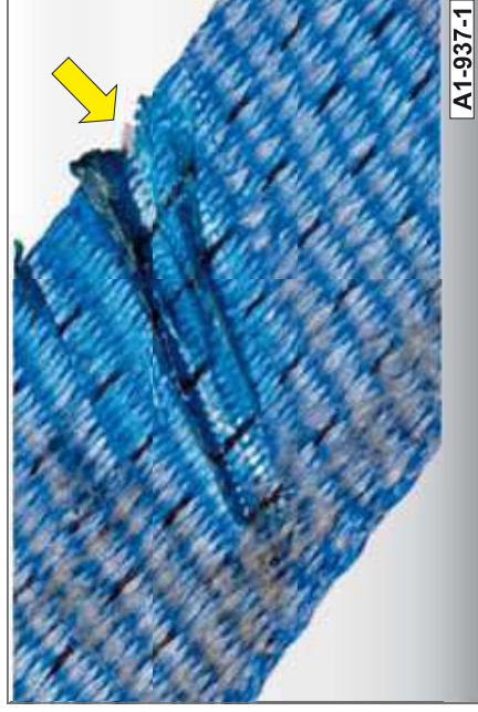
Fig. 92 Criterio di controllo 2 - cinghia di fissaggio
