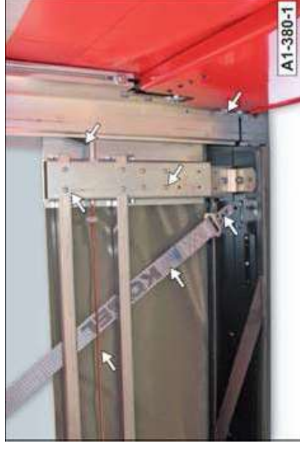
Fig. 82 Collegamento del tetto posteriore
