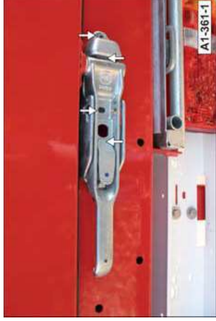
Fig. 86 Chiusura inferiore della porta
