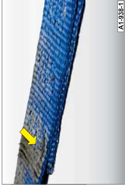
Fig. 93 Criterio di controllo 3 - cinghia di fissaggio
