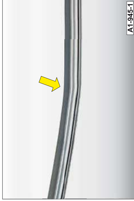
Fig. 100 Criterio di controllo 10 - traverse di carico
