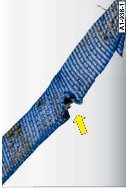
Fig. 91 Criterio di controllo 1 - cinghia di fissaggio
